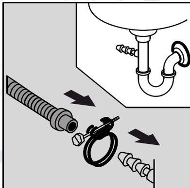
1. Закрепите наконечник на сифоне с помощью зажимного хомута, прилагаемого к прибору\*.
