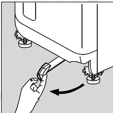
1. Для перемещения стиральной машины достаточно установить ее на колесики, вытянув до упора справа налево рычаг, предусмотренный в нижней части прибора. После установки прибора в нужное место приведите рычаг в исходное положение.
