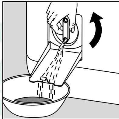
2. Поставьте внизу какую-нибудь емкость. Поверните заглушку против часовой стрелки так, чтобы она приняла вертикальное положение и чтобы оставшаяся вода могла вытечь.
