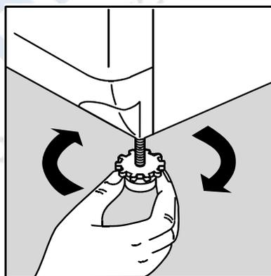
2. Точное выставление прибора по уровню позволяет предотвратить вибрации, шум и смещение прибора во время работы. Выровняйте прибор, регулируя самую короткую ножку. Развинтите целиком ножку и соединительную муфту (при необходимости поднимите прибор).
