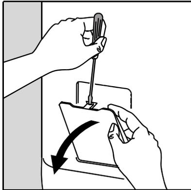
1. Откройте дверцу, например, с помощью отвертки.
