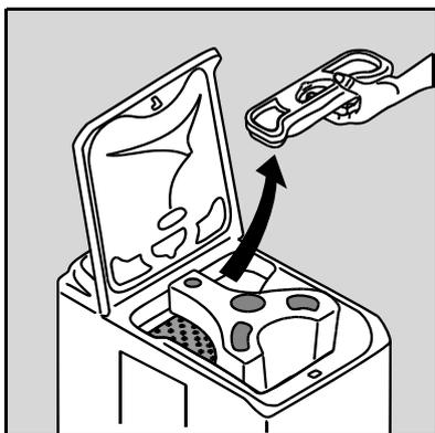
5. Выньте дозатор из отсека, потянув его вверх.
