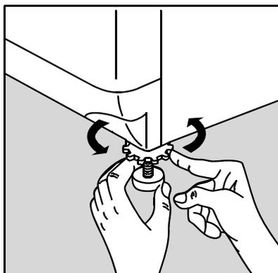
3. Когда прибор принял устойчивое положение, закрепите ножку на полу и максимально завинтите соединительную муфту.
